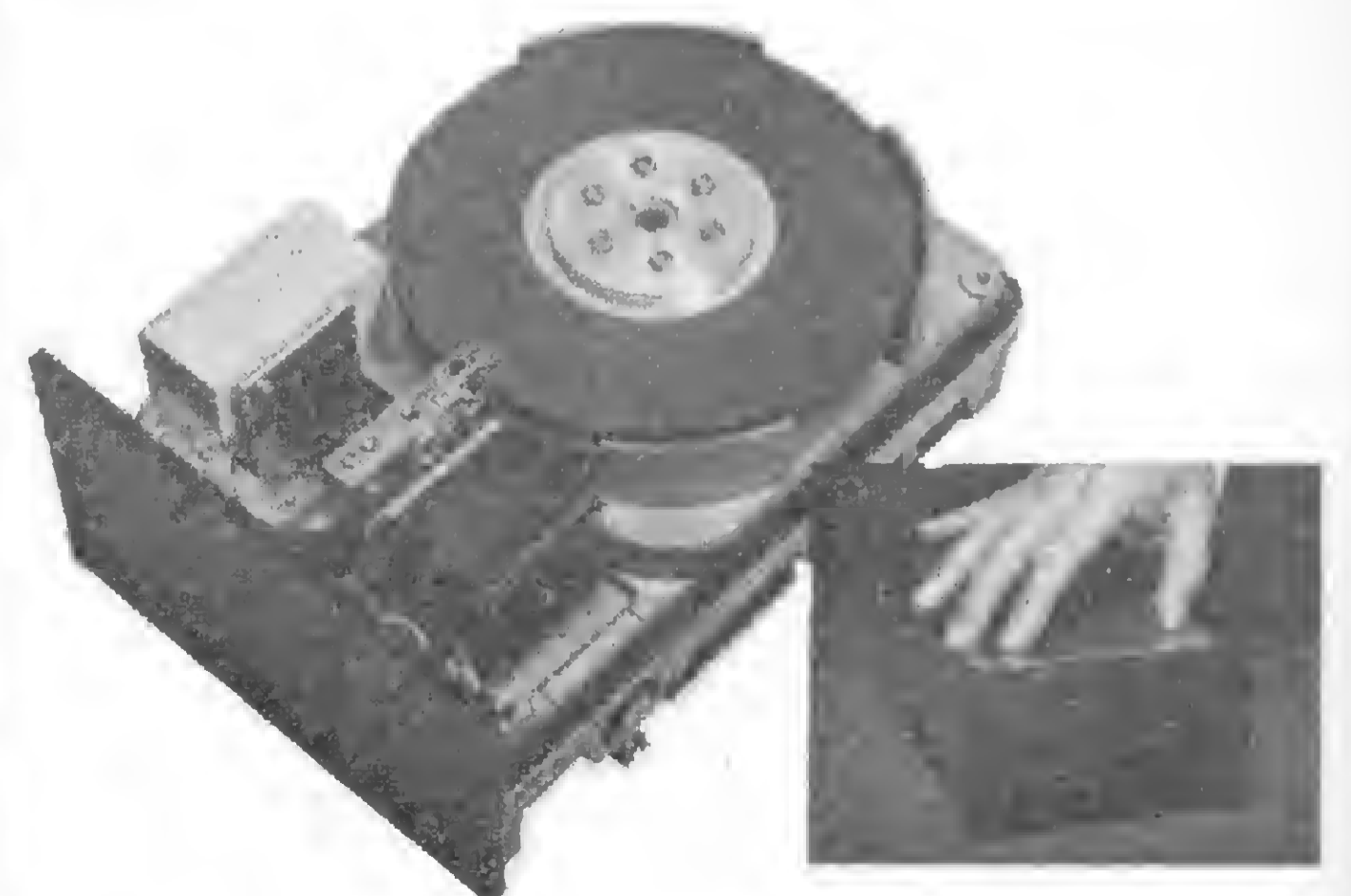
A miniaturização está se comprovando cada vez mais como uma tendência de todos os fabricantes, como podemos ver por esta unidade de disco rígido Winchester com capacidade para até 12,8 Mbytes, desenvolvida pela MiniScribe. É o prenúncio do fim dos pouco práticos "armários" dos tradicionais discos rígidos.
